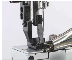
Çift baskı ayağı senkronize besleme Double presser foot synchronous feeding
