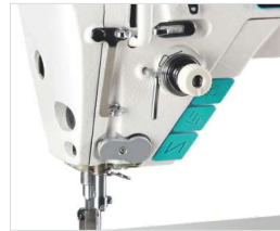
Elektronik iplik tutucu, LED lamba, zigzag dikişi tek parçada birleştirildi.
